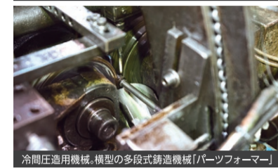
冷間圧造用機械・構造的多段式鋳造機械「パーツフォーマー」
