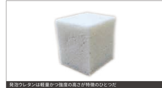
発泡ウレタンは軽さかつ強度の高さが特徴のひとつだ
