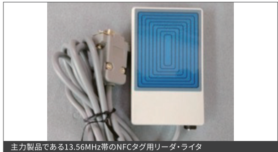
主力製品である13.56MHz帯のNFCタグ用リーダ・ライタ
