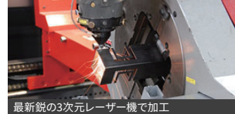
最新鋭の3次元レーザー機で加工
