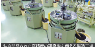
独自開発された高精度の研磨機を備える製造工場
