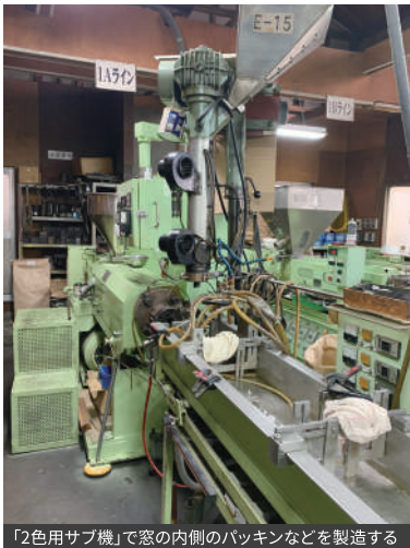
「2色用サブ機」で窓の内側のパッキンなどを製造する
