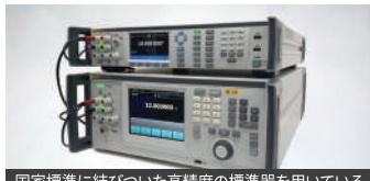
国家標準に結びついた高精度の標準器を用いている
