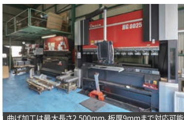
曲げ加工は最大長さ2,500mm、板厚9mmまで対応可能
